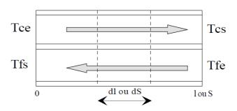
On note  $m_c$  et  $m_f$  les débits massiques des deux fluides,  $c_{pc}$  et  $c_{pf}$  leurs chaleurs massiques à pression constante.
