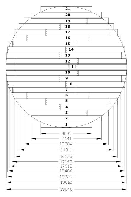
Recouvrement longitudinal : 100 mm Recouvrement transversal : 150 mm
