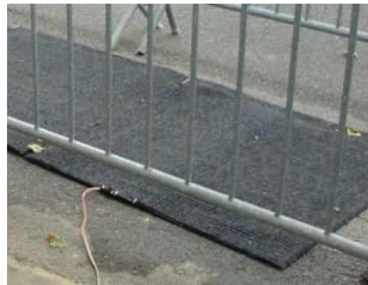
**Figure 6 : un tapis-antenne**
