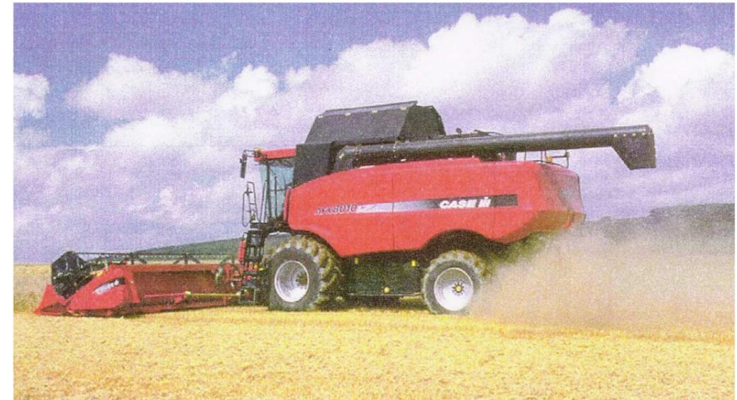
**MOISSONNEUSE-BATTEUSE A BATTEUR AXIAL
