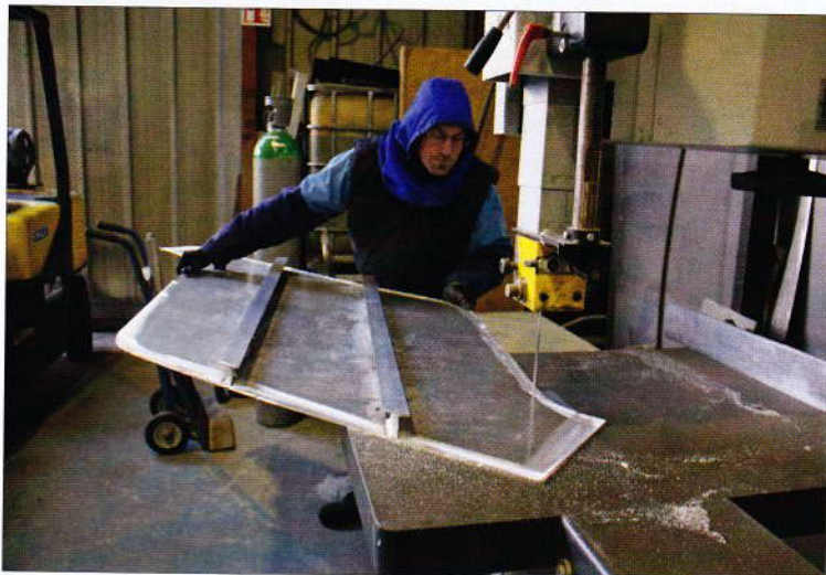
Les plaques d'aluminium arrivent prédécoupées au chantier mais nécessitent souvent un petit travail de rectification.
