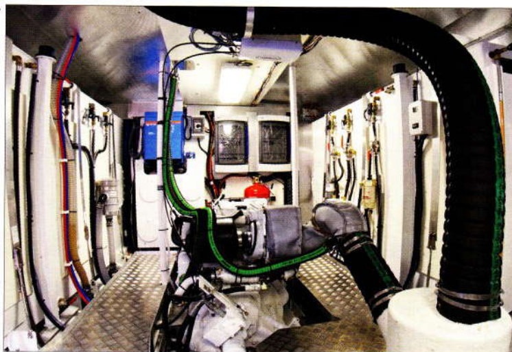
Pour renforcer la stabilité et l'équilibre du trawler, le compartiment moteur est situé au centre du bateau. Il accueille un 185 ch CAT.
