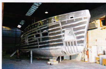
À la fin janvier, le travail de chaudronnerie de l'imposante coque en aluminium est pratiquement terminé.
