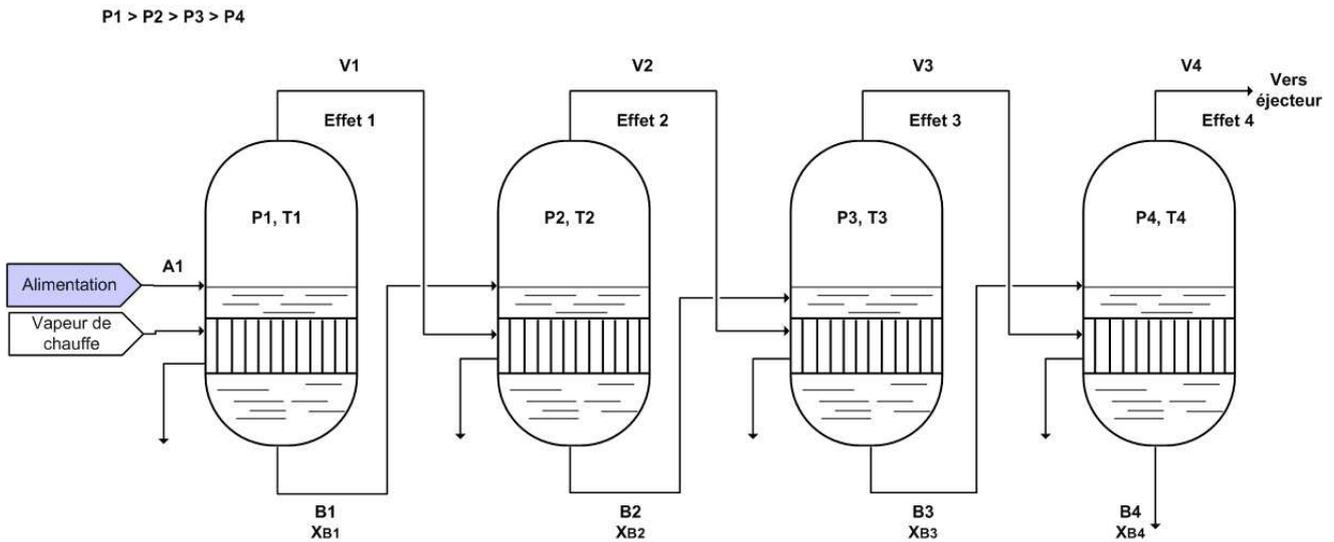
5.1. Surligner en trait plein le circuit de solution de soude et en pointillés le circuit de vapeur de chauffe et de solvant dans le schéma ci-dessus. (2 pts)
