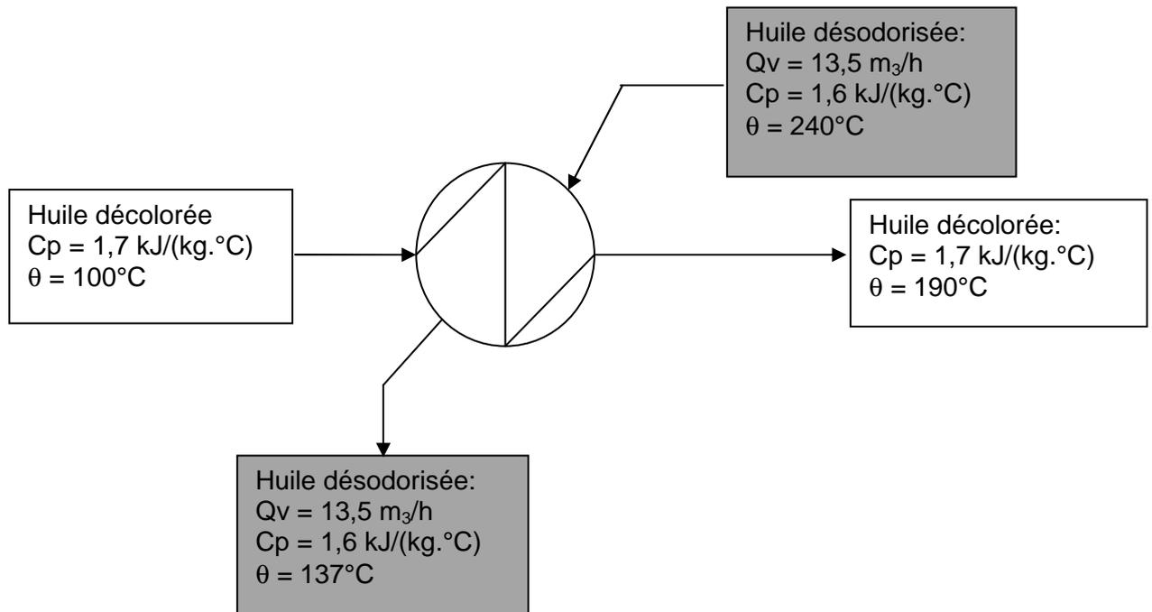
**3.1. Précisez le sens de circulation des flux (co-courant ou contre-courant). Justifiez votre réponse en traçant les profils de températures.** (1 pt)
