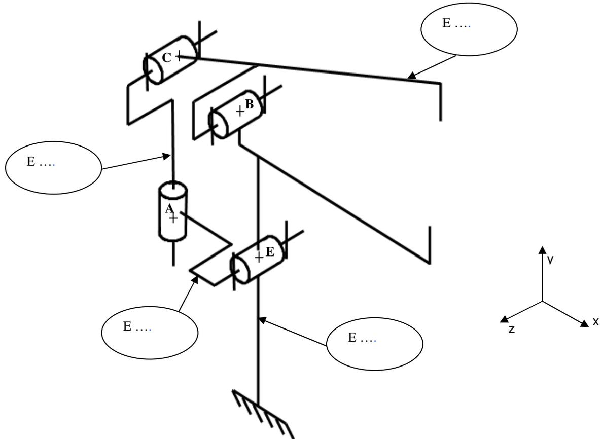
**Q2.4 :** Compléter le tableau suivant en indiquant les degrés de liberté (par « 1 » s'il existe et par « 0 » s'il n'existe pas) et le nom des liaisons correspondantes.
