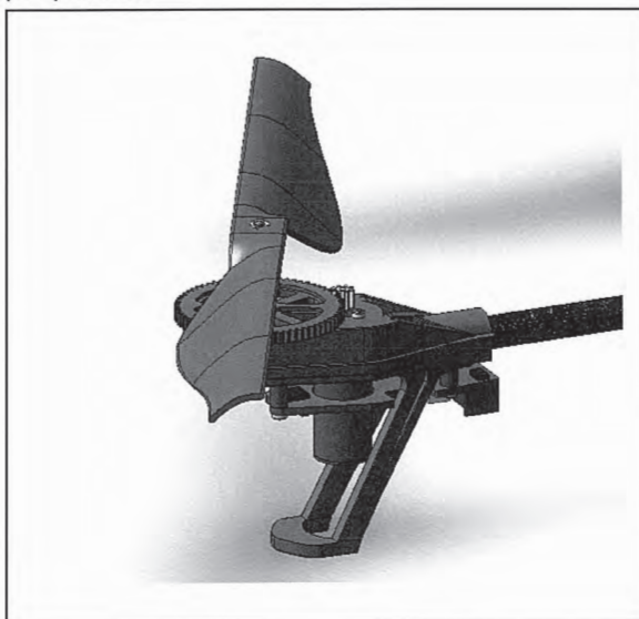
Vue de détail d'un groupe de propulsion
