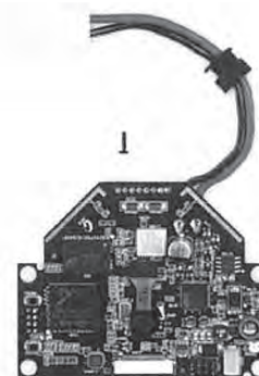
Fig. Carte mère intégrant le chipset wifi et l'antenne imprimée
