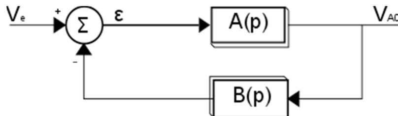
Figure 12 – Système bouclé équivalent au montage non inverseur à AO.
