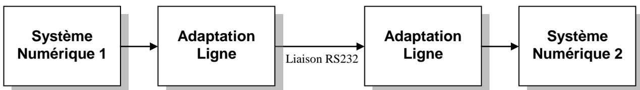
La transmission série nécessite un minimum de 2 fils supportant les trames de données en émission (**Tx**) et en réception (**Rx**).
