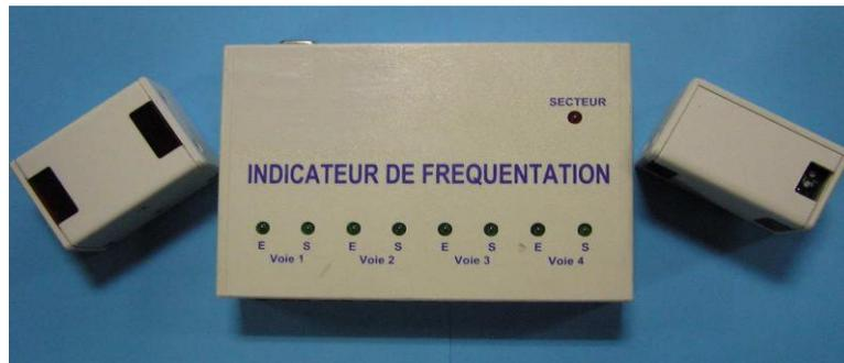
Ce système peut être installé dans un magasin, un musée, un parc d'attraction ou tout autre domaine nécessitant une surveillance et une comptabilisation de la clientèle en temps réel. Relié à un ordinateur par une liaison RS232, un logiciel permettra de déduire sous forme de tableaux ou de graphiques le nombre d'entrées sorties, de clients présents à un instant donné et de visualiser ces informations par tranche horaire.
