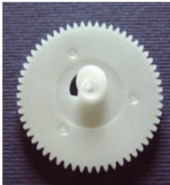
POM - 1 cavité - buse ewikon 3 points
