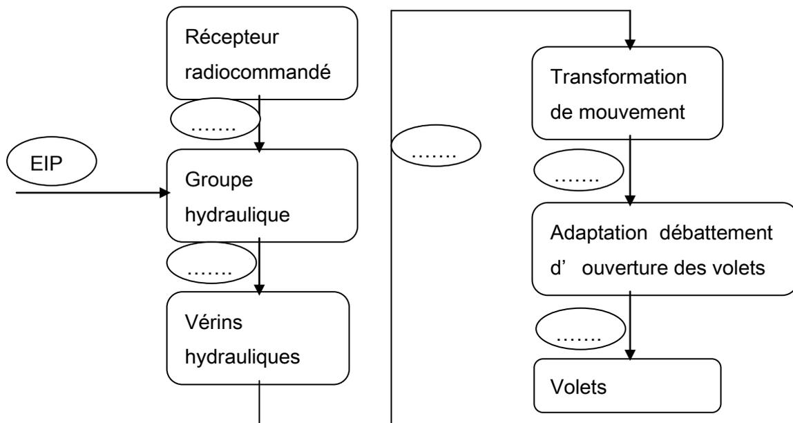
1-4 Entourer les solutions constructives de la partie mécanique sur le FAST partiel ci-dessous :
