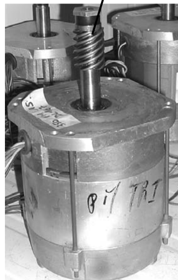
Ensemble moteur – vis arbrée
