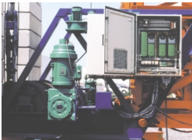
Levage de charges contrôlé par variateur de fréquence
