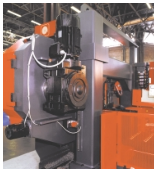
Découpage : entraînement de la lame de la scie
