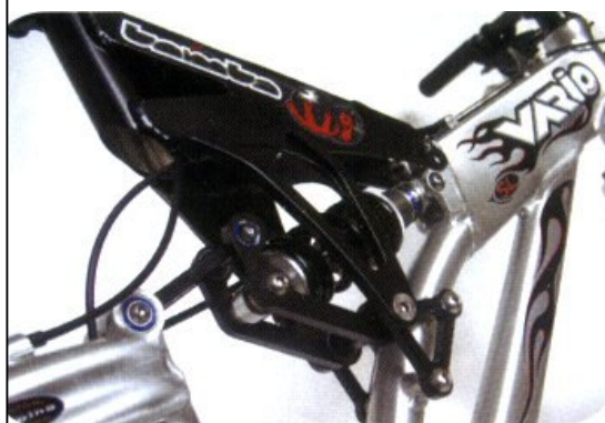
Vue de détail du mécanisme de suspension.
