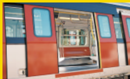
Portes ES-2 Faiveley choisies par Kinky Sharyo et Kawasaki pour le métro du réseau KCRC de Hong Kong.
