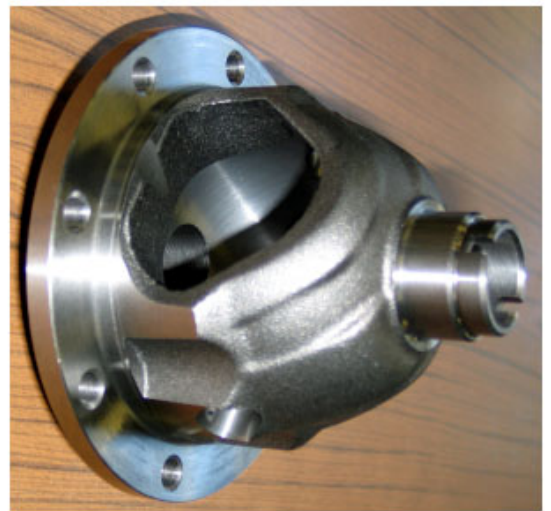
Boîtier du pont différentiel
