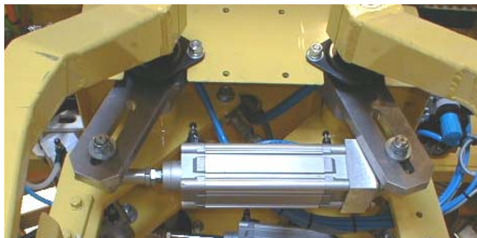
Vérin A d'ouverture et de fermeture de la pince (vérin rentré au repos et pince fermée)
