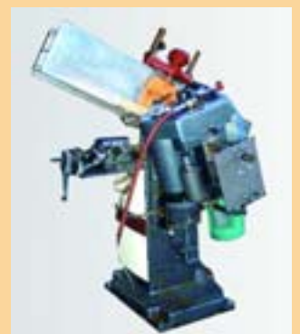
Mortaiseuse spéciale pour réaliser des coupes d'onglets
