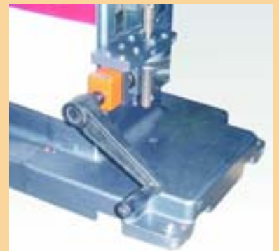
Système de monte et baisse de l'unité par manivelle et compteur mécanique numérique
