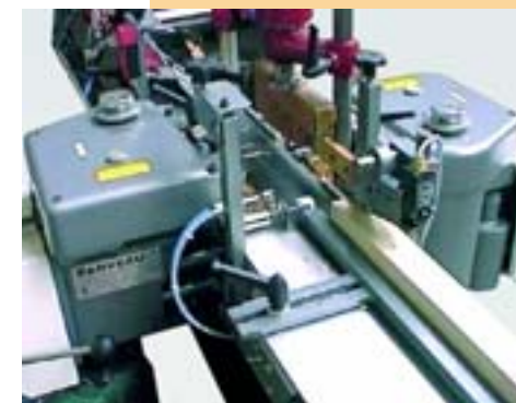
Mortaiseuse spéciale à 2 unités en vis-à-vis
