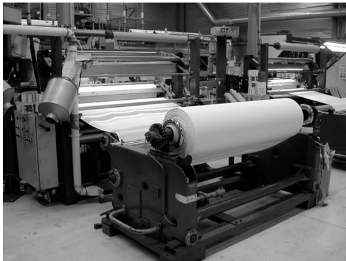
Illustration 1: Machine d'inspection de tissu - Vue d'ensemble
