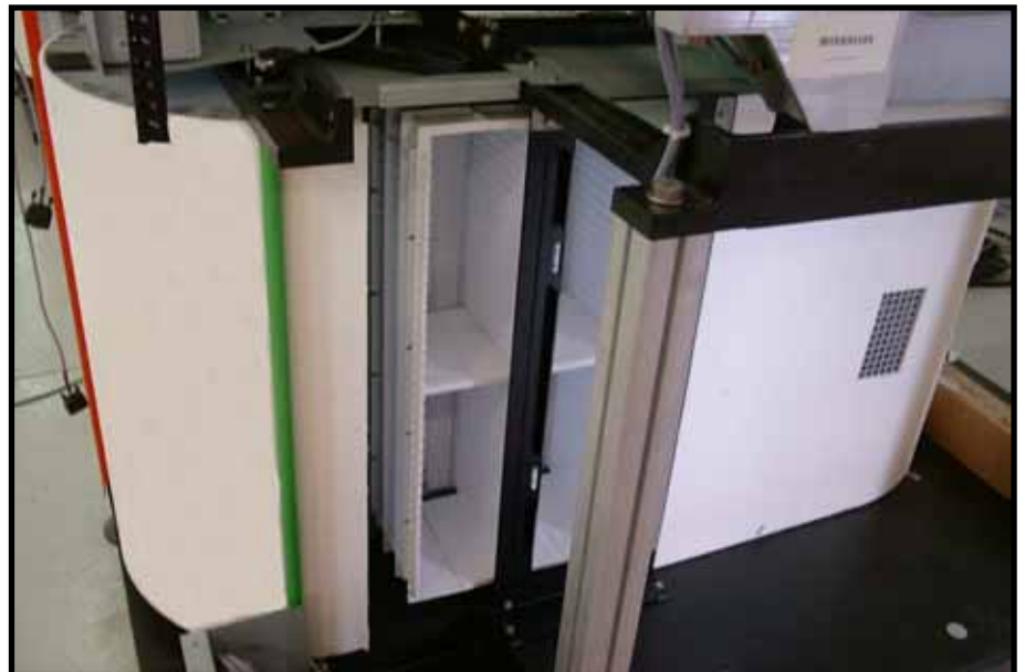
VUE DU CARROUSEL DE STOCKAGE DES DOSETTES EN PARTIE BASSE DE L'AUTOMATE
