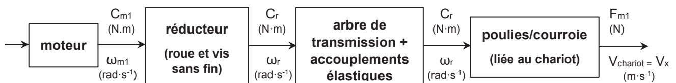
Figure 12 : Synoptique transmission de puissance axe n°1
