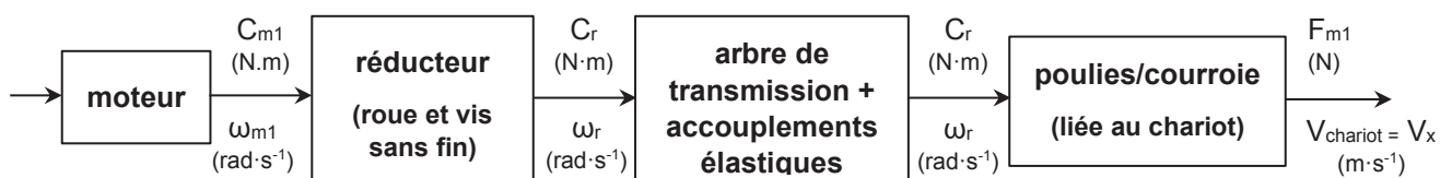
Figure 12 : Synoptique transmission de puissance axe n°1
