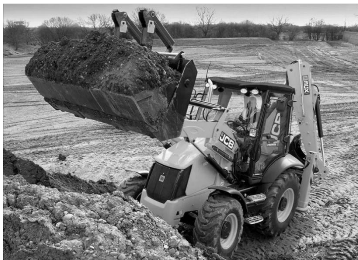
Figure 3 : sur-volume du godet
