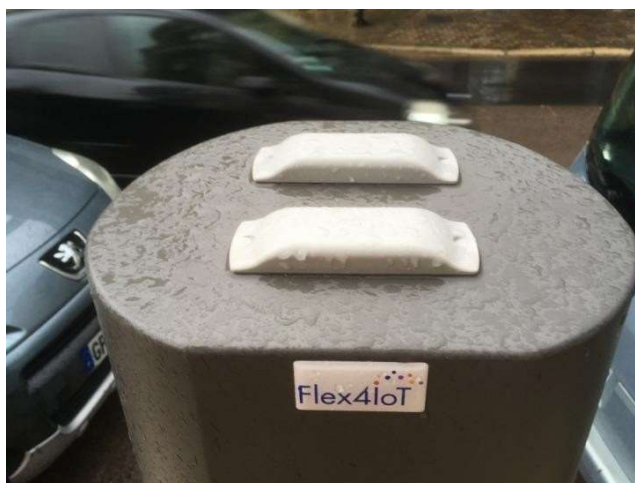
Photo des antennes émettrices LoRa installées pour la rénovation
