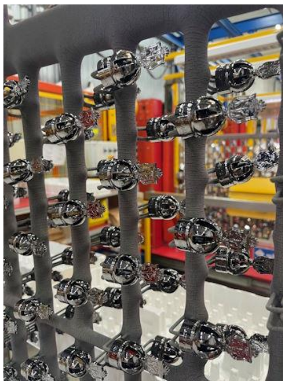
Montage des bouchons sur support industriel
