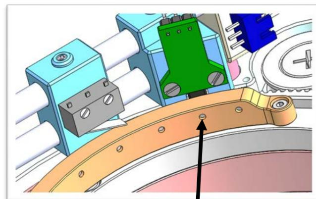
Aimant détecté par le capteur à
