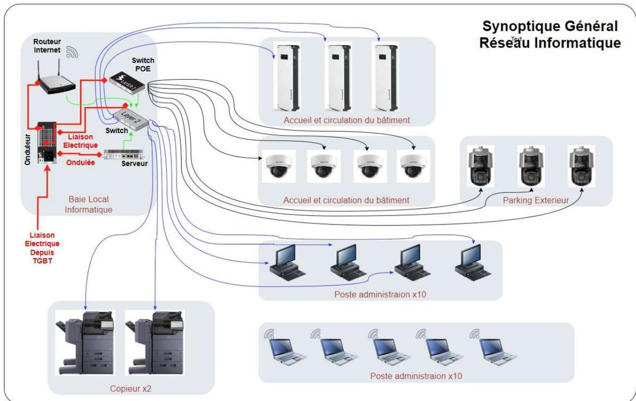
Afin de mettre en œuvre la vidéo surveillance du site et notamment sur les espaces extérieurs, des choix technologiques s'imposent afin de passer les câbles, les raccorder et de préparer l'intervention en sécurité dont l'installation des différents équipements (Switch P.O.E., Caméra Dôme sur mat extérieur).
