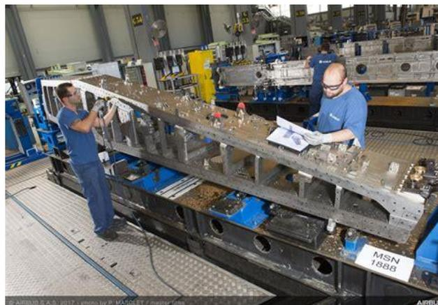
*Figure 4 : Assemblage mât réacteur.*
