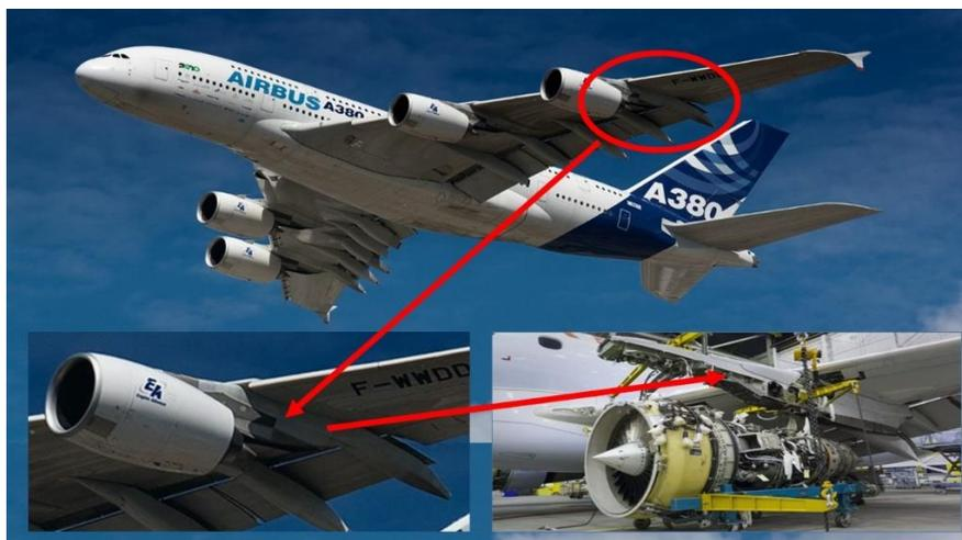
*Figure 2 : Mât réacteur sous voilure*
