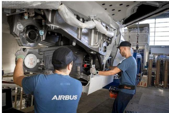
Figure 6 : Installation du mât sur A350
