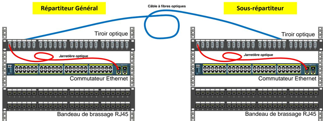
***Tous les commutateurs Ethernet du réseau du Mémorial disposent de ports Gigabit qui peuvent être équipés de modules optiques SFP dont les caractéristiques sont données en annexe 22.***
