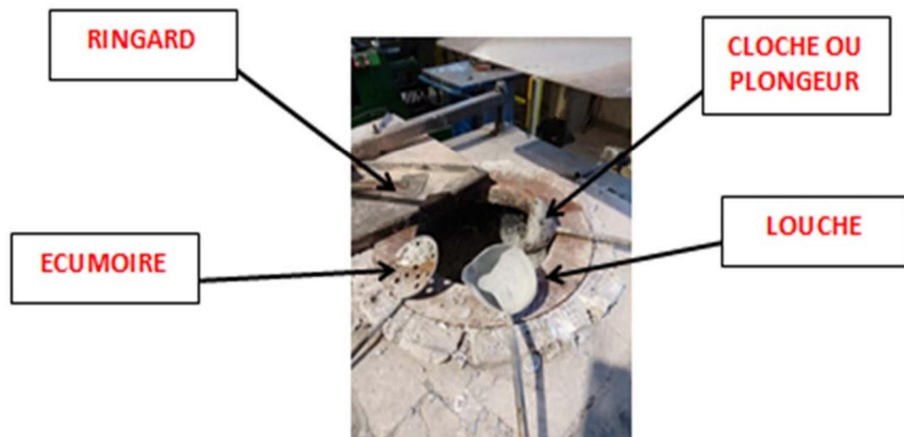
Lorsque le bain d'alliage est à température de traitement, un test semble nécessaire afin de contrôler la présence de gaz (hydrogène) dans l'alliage liquide.
