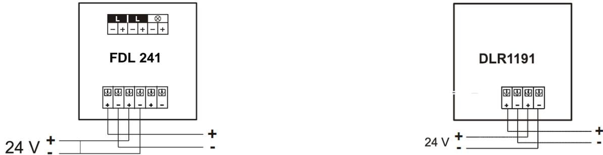
Figure 11 : schéma de raccordement pour l'élément chauffant de l'émetteur/récepteur et du réflecteur longue portée
