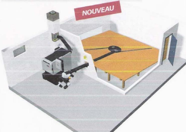
La variante la plus courante pour l'alimentation du bois déchiqueté. Lors du remplissage, les ressorts se placent autour de la tête du déssileur sous le plateau du mélangeur et réduisent la résistance lorsque le silo est plein.
