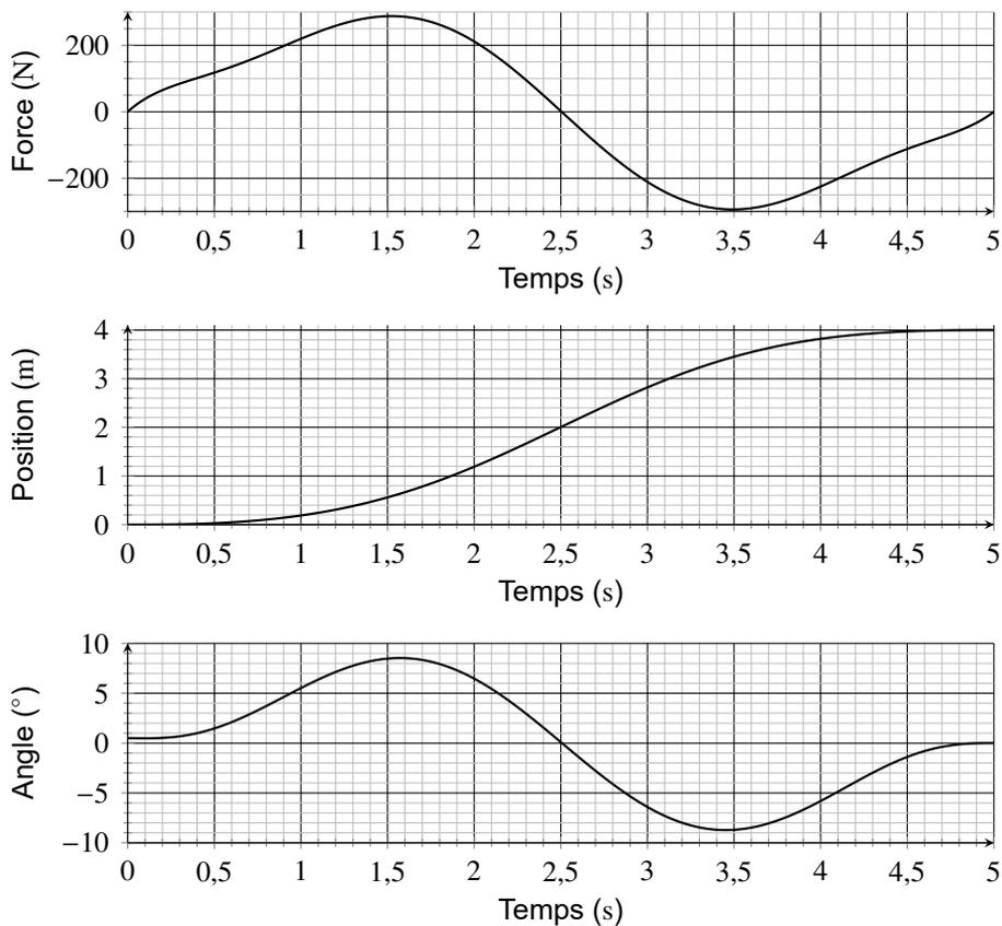
**Figure 12** - Réponses temporelles en contrôlant la consigne de la boucle ouverte
