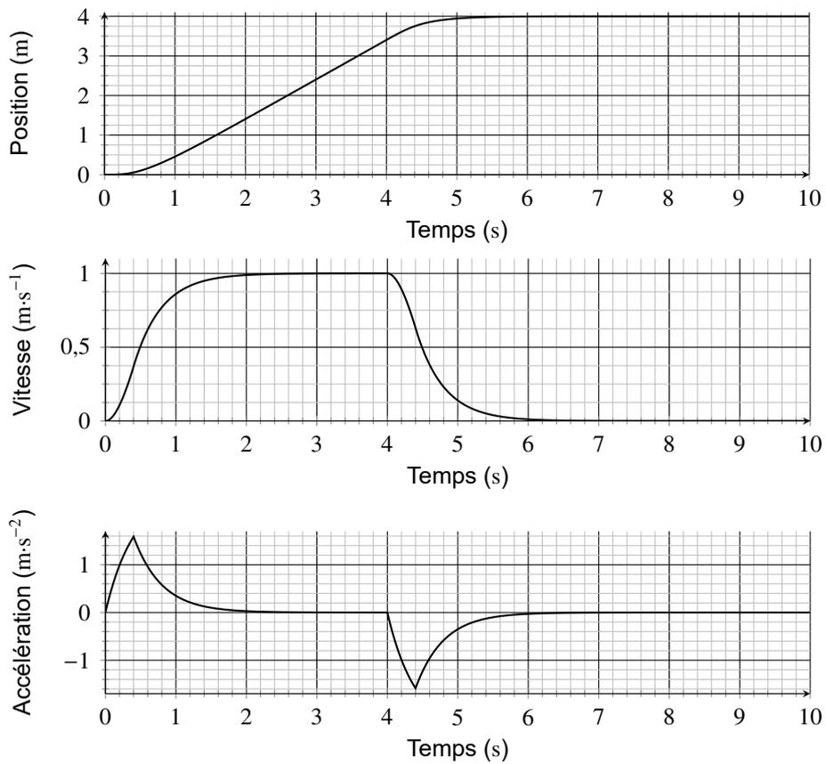
**Figure 6** - Réponses temporelles pour une consigne de tension en trapèze
