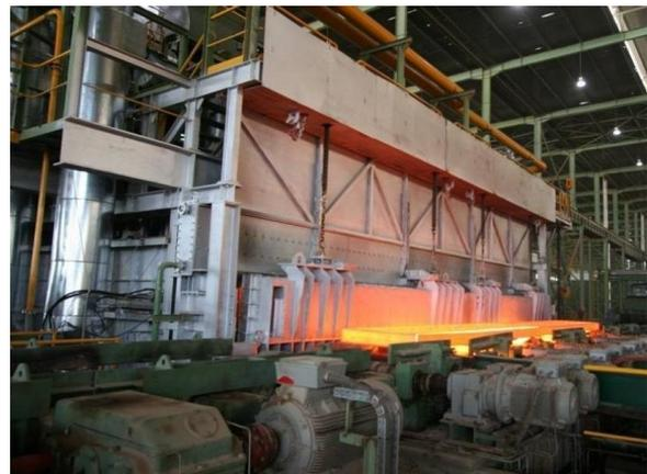
Figure 5 - Brame chaude à la sortie du four à brame
