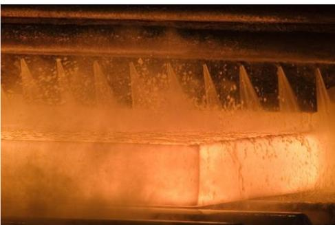
Figure 8 - Brame chaude au poste de décalaminage
