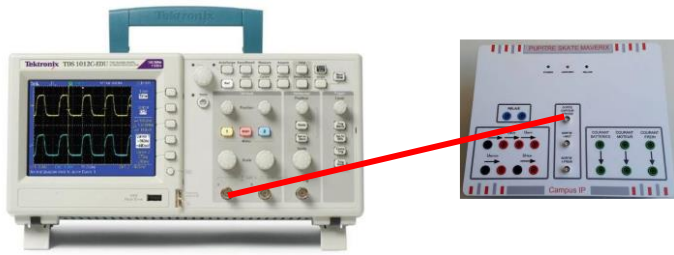
Figure 3 : schéma de câblage de la mesure de la vitesse de rotation
