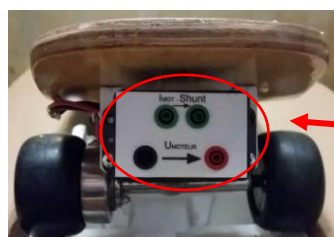
Figure 3 : schéma de câblage de la mesure de la puissance
