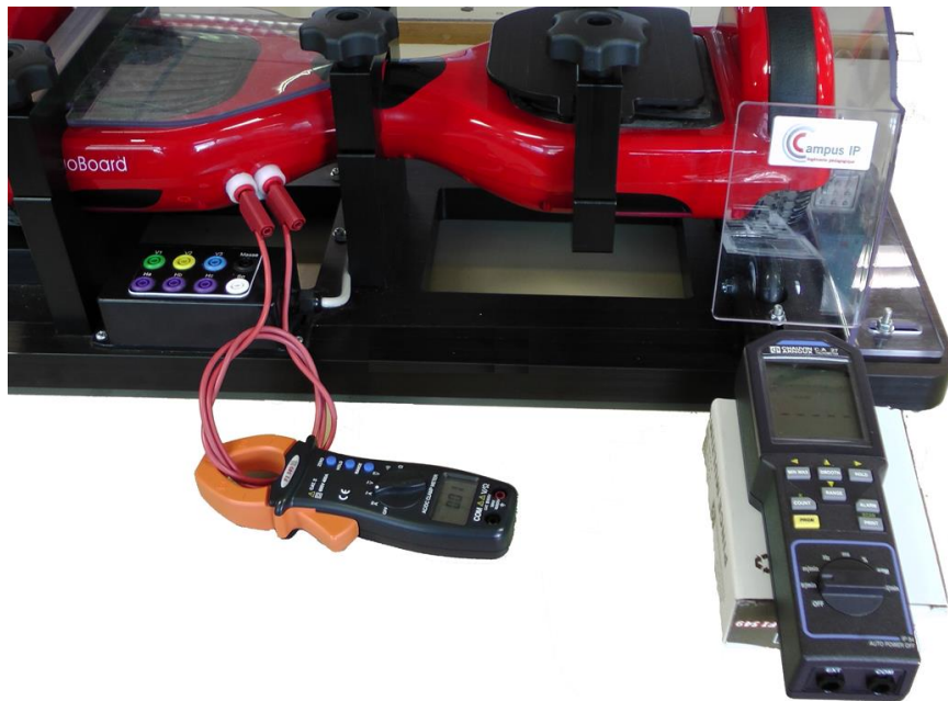
Figure 3 : raccords des différents appareils de mesure
