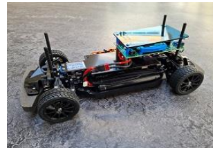
Figure 1 : voiture Tamiya seule et interface de commande
