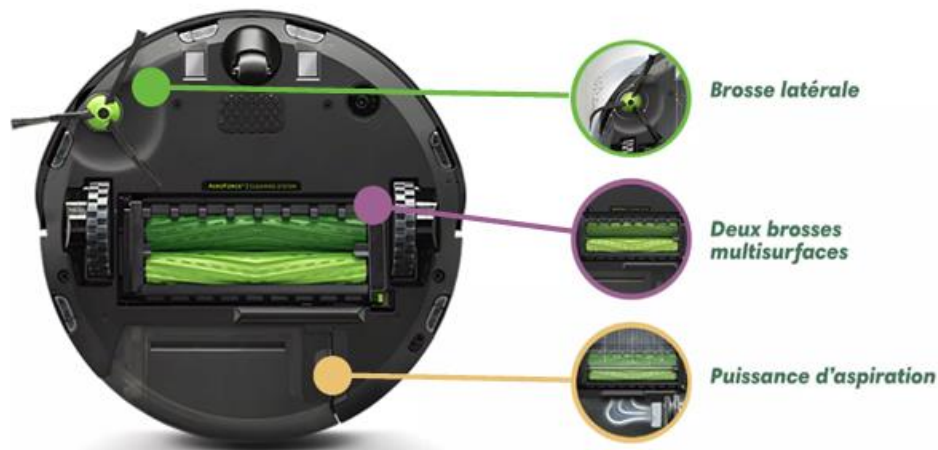
Figure 1 : vue de dessous du processus breveté de nettoyage
