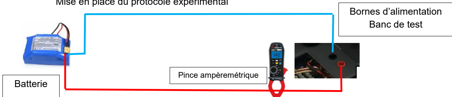
Figure 4 : schéma de câblage de la mesure du courant
