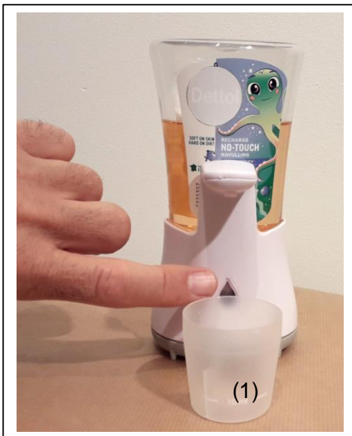
Figure 3 : procédure de mesure de la masse de produit distribué.
