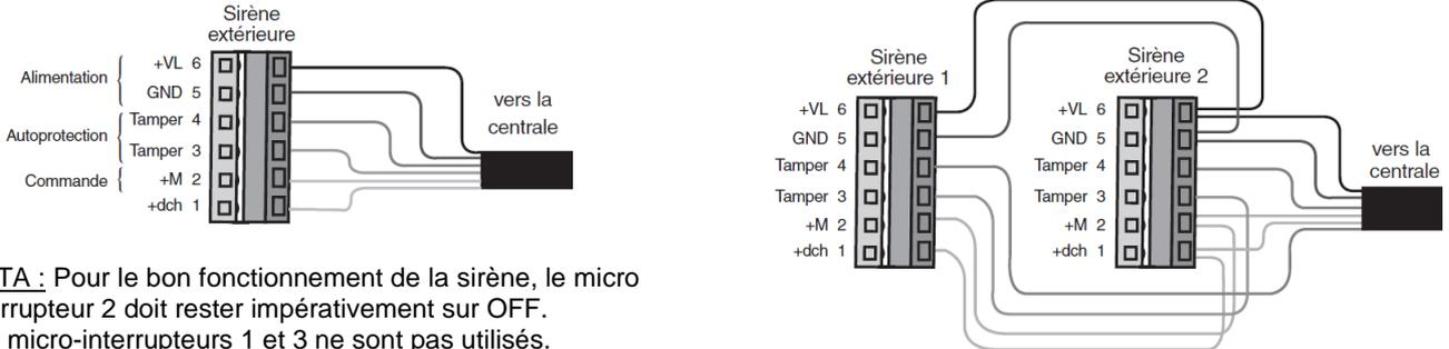
**NOTA :** Pour le bon fonctionnement de la sirène, le micro interrupteur 2 doit rester impérativement sur OFF. Les micro-interrupteurs 1 et 3 ne sont pas utilisés.
