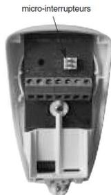
La borne NC peut être utilisée pour ajouter une résistance de bout de ligne sur le détecteur le plus éloigné (valeur 15 kΩ, livrée avec la centrale Logisty). Celle-ci permet la détection d'un court-circuit sur la boucle de détection.
