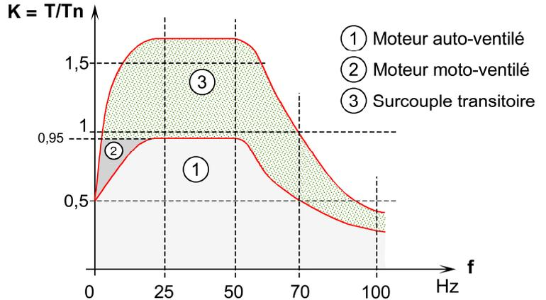
**Exemple :** Un moteur auto-ventilé (1) fonctionnant sous une fréquence variable de 25 Hz à 50 Hz se verra appliquer un coefficient de déclassement  $K = 0,95$ .
