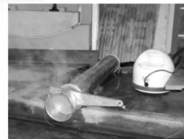
Vaporisateur artisanal : un générateur de vapeur ménagé, un tuyau d'aspiration avec un système de guillotine, cela permet déjà de cintrer des bois en petite série.
