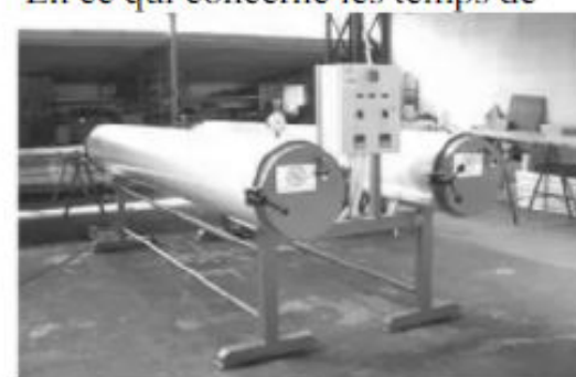
Vaporisateur industriel à double autoclave. Utilisé pour des travaux de série.
