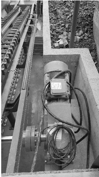
Figure 1 : Moteur de l'élévateur
