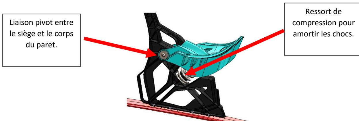
Le YOONER existant impose une position pour une taille unique, pas de réglage en hauteur du siège.
