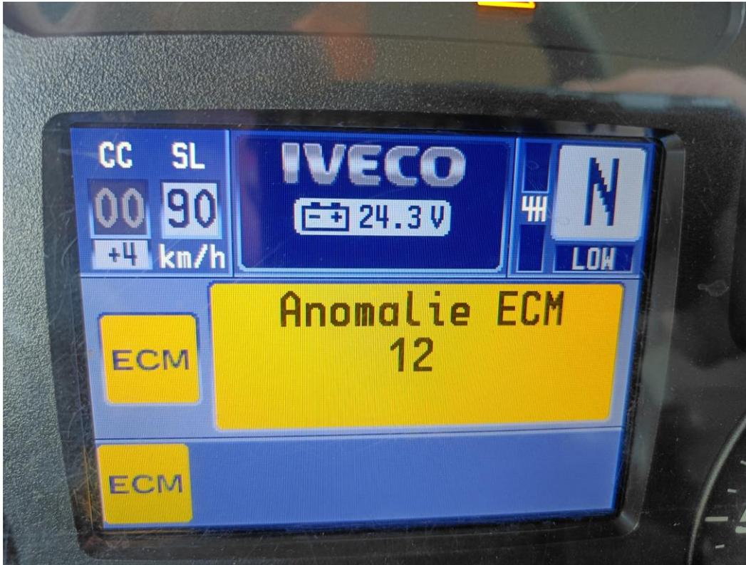
On remarque que le voyant ECM (Engine Control Module) est bien allumé en orange, ce qui traduit par un dysfonctionnement sur le système ECM.
