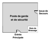
La porte est équipée d'un détecteur d'ouverture/fermeture magnétique à <u>contact NF</u>. Ce contact est relié à l'une des entrées d'alarme du serveur de gestion vidéo. Ce serveur vidéo est installé dans la baie de brassage informatique du poste de garde et de sécurité.
