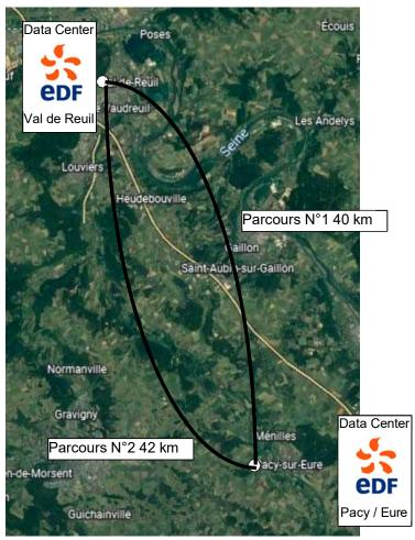
De façon à assurer une haute disponibilité, une répartition de charge de calcul et de stockage des données clients, les deux Data Center EDF sont raccordés au moyen de deux fibres optiques aux parcours différents comme le montre la figure ci-dessus.
