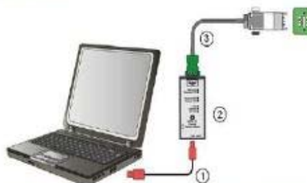
Schéma de câblage lors de l'utilisation d'un UDA2-CS avec connecteur 6 pins et un nouveau câble HSI
